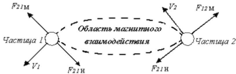
Рис. 6. То же магнитное взаимодействие, но показаны силы инерции, уравнивающие магнитные силы
