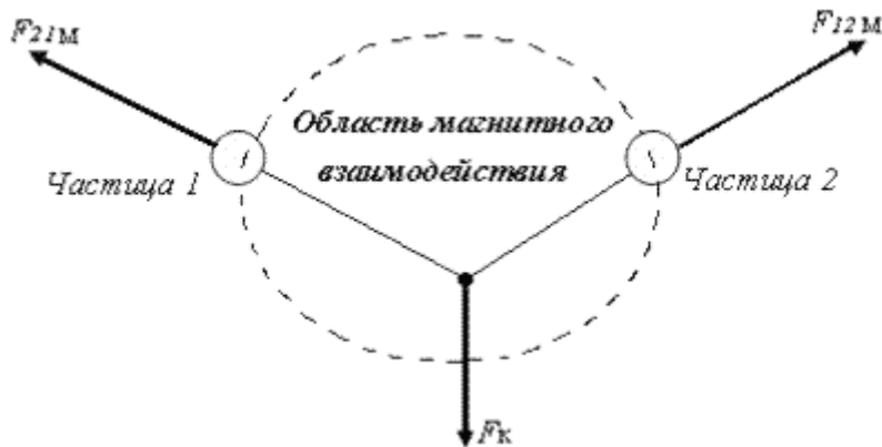
Рис. 7. Статическое равновесие области магнитного взаимодействия частиц 1 и 2
