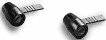
Рис. 6.10. Датчики ультразвукового сканера
