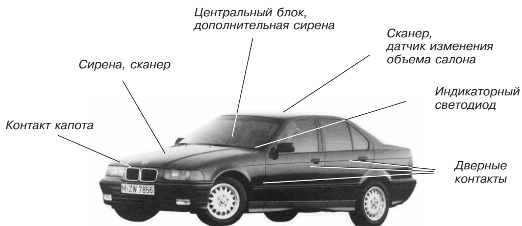
Рис. 6.8. Расположение блоков и датчиков в автомобиле
