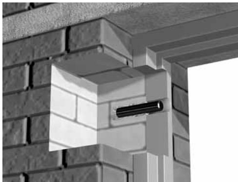
Рис. 2.3. Усиление соединения дверной коробки со стеной
