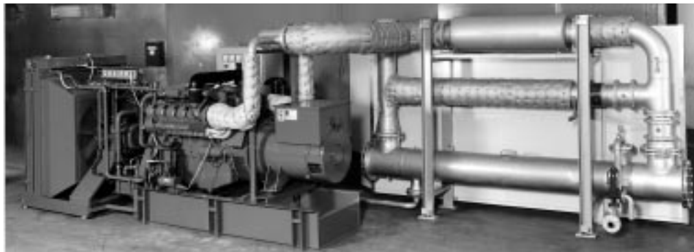
Рис. 4.2. Дизельный агрегат с двигателем Mercedes (электрическая мощность 500 кВт)
