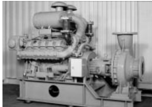
Рис. 4.5. Автономный насос с дизельным приводом (тип RG-319/PP/1800)
