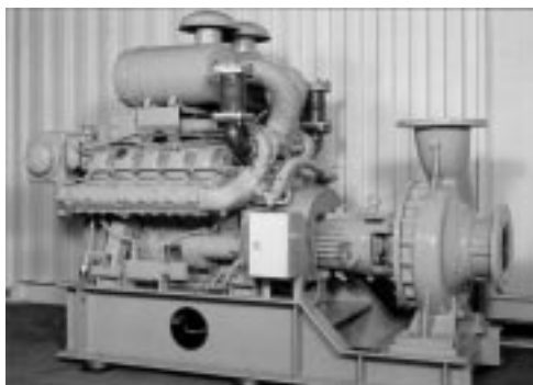
Рис. 4.5. Автономный насос с дизельным приводом (тип RG-319/PP/1800)
