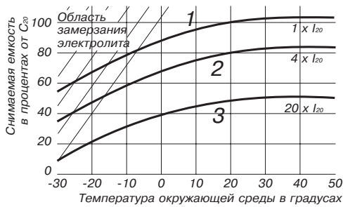
Рис. 2.18. Остаточная снимаемая емкость при разряде постоянным током
