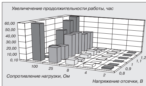
Рис. 1.3. Сравнительная диаграмма прерывистого и непрерывного режимов работы D-элементов
